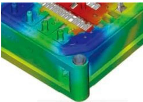
**双色成型分析** 对双色成型工艺进行仿真分析：填充一个零件，然后打开模具，后模旋转到新位置，在第一个零件上方注射第二个零件。
