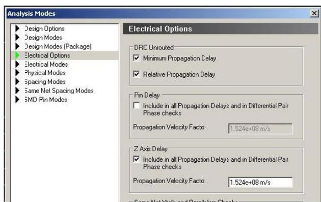
另外需要注意的是在启用以上功能之前应该把相应的层叠参数设置正确以得到正确的计算结果。
