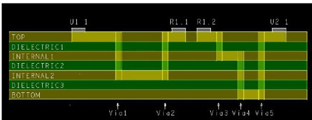
图中的层叠含有走线层 TOP、INTERNAL1、INTERNAL2、BOTTOM 和三个介质层，此 Xnet 从 U1.1PIN 通过电阻 R1 然后到 U2.1PIN，走线路径上包含了 5 个 Via，通常计算 Z 轴的长度就是将走线经过的所有层的厚度相加。第一个 Via (Via1) 就是一个很好的例子。信号从 Top 层的上表面完全穿越 TOP、DIELECTRIC1、INTERNAL1、DIELECTRIC2 然后再次上升到 R1.1PIN。TOP、DIELECTRIC1、INTERNAL1、DIELECTRIC2 的厚度将被计算在内，注意 INTERNAL2 厚度不被计算在内，因为信号没有完全穿越 INTERNAL2 层。
