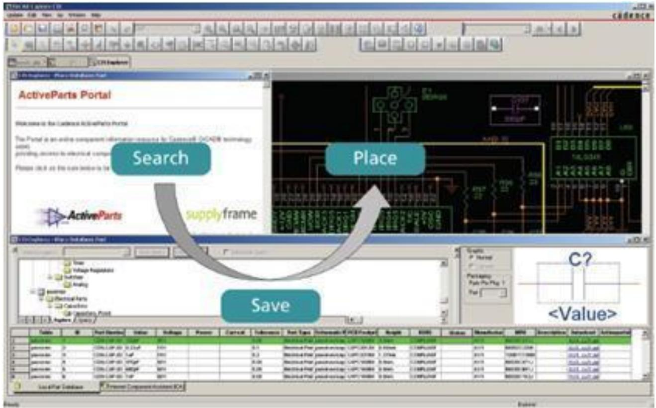
对于 Cadence OrCAD Capture CIS 用户而言 Active Parts 是 Cadence 和 Supply Frame 传媒集团为现有的全部 OrCAD Capture CIS 用户免费提供的电子元件在线数据库。Active Parts 在线数据库使得用户可以调用网络中数以百万计的元件，其中包括业界最新的元件，而且这些元件大多数都带有 OrCAD Capture 符号，可快速置入电路原理图设计中。这样，用户的设计灵活性达到了全新水平，他们只需通过 Active Parts 在线搜索即可调用所需元件，不再局限于当地数据库中的元件信息。
