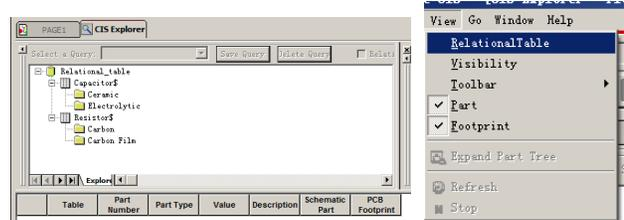
根据参数或查询条件选中设计所需的物料, 这时与物料相关的属性将完全呈现出来。
