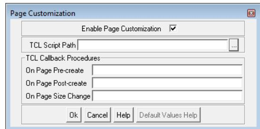
勾选 Enable Page Customization 选项，并点击浏览，将 TCL Script Path 指向 C:\Cadence\SPB\_16.6\tools\capture\tclscripts\capCustomSamples 目录下的 capCustomizePage.tcl 文件。在下面的三个 TCL Callback Procedures 中分别填写:
